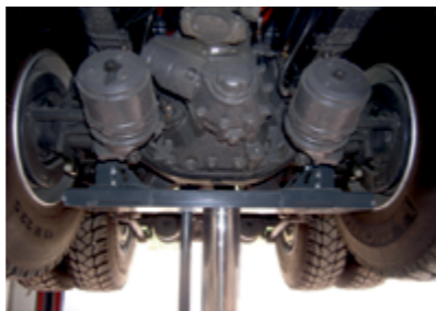
Menteşeli harici açılan rot kolları için travers kaydırma takozları
