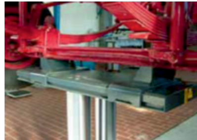
Dövme çelikten yapılmış akslar için kaydırma pleytleri
